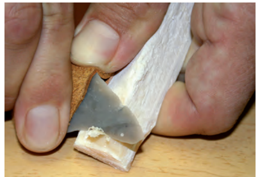
Abb. 5: Schnitzfähigkeit nach Einlegen in Oxalsäurelösung.
