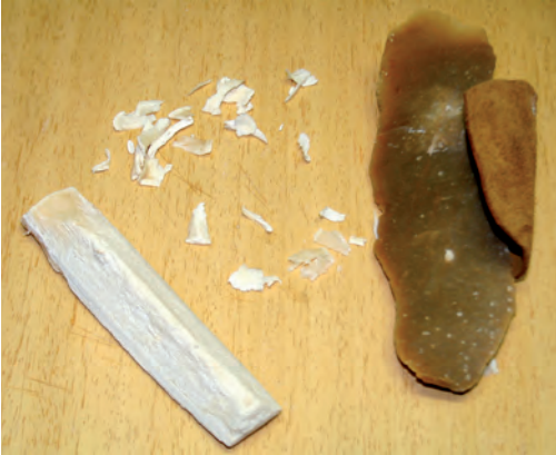
Abb. 6: Schnitzspäne nach Einlegen in Oxalsäurelösung.
